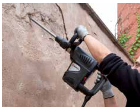
Regolazione elettronica per selezionare numero di giri e forza dei colpi
