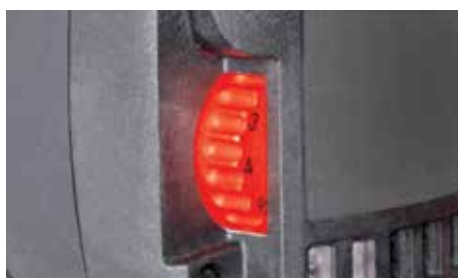
Regolazione elettronica per selezionare numero di giri e forza dei colpi
